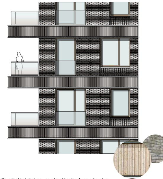
Gemetselde bakstenen gevel met houten Accoya banden. Hierdoor zijn lichtere balkons mogelijk.
