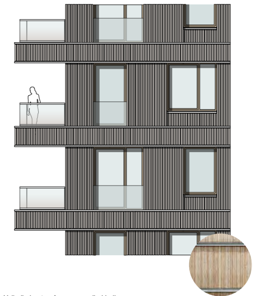
Volledig houten Accoya gevelbekleding. (Voldoet niet aan het beeldkwaliteitsplan).
